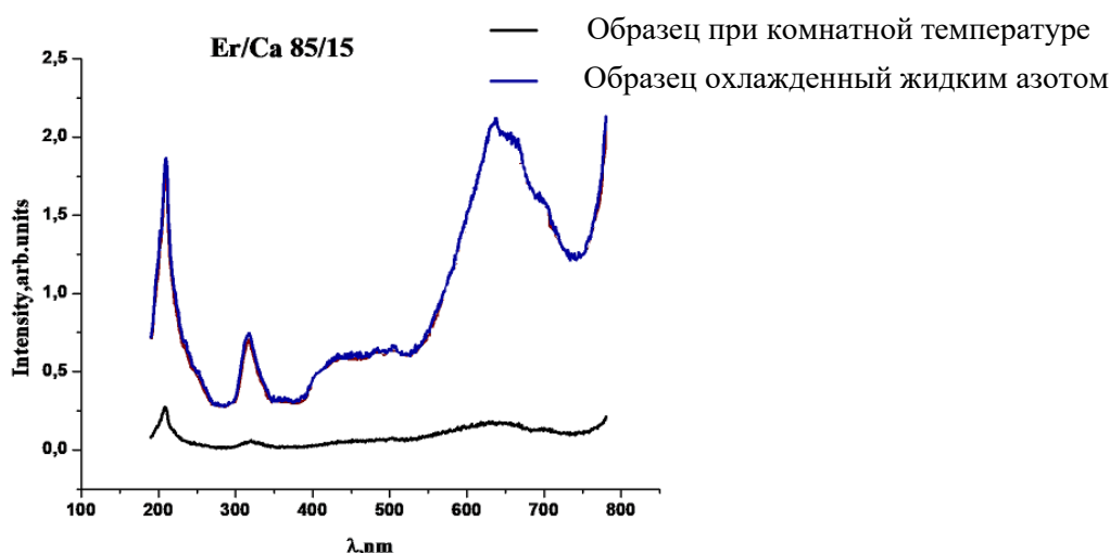
Рис.3. Спектр люминесценции \text{ErF}_3/\text{CaF}_2 85%/15% при мощности лазера 1,44 Вт, при охлаждении образца жидким азотом
