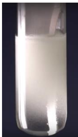
Рис. 4. Реакция железа с сульфосалициловой кислотой
