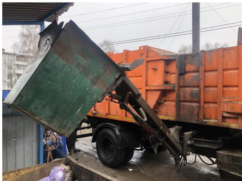
Рис. 2. Использование оборудования мусоровоза при взвешивании контейнеров с ТКО
