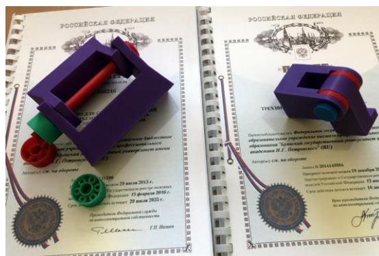
Рис. 2. Выставочные макеты и образцы, изготовленные на 3D-принтере совместно со студентами: а) действующий макет мобильной канатной дороги [2]; б – макеты шарнирных соединений транспортно-технологических машин, лежащие на информационных буклетах, поясняющих ход выполнения научных исследований
